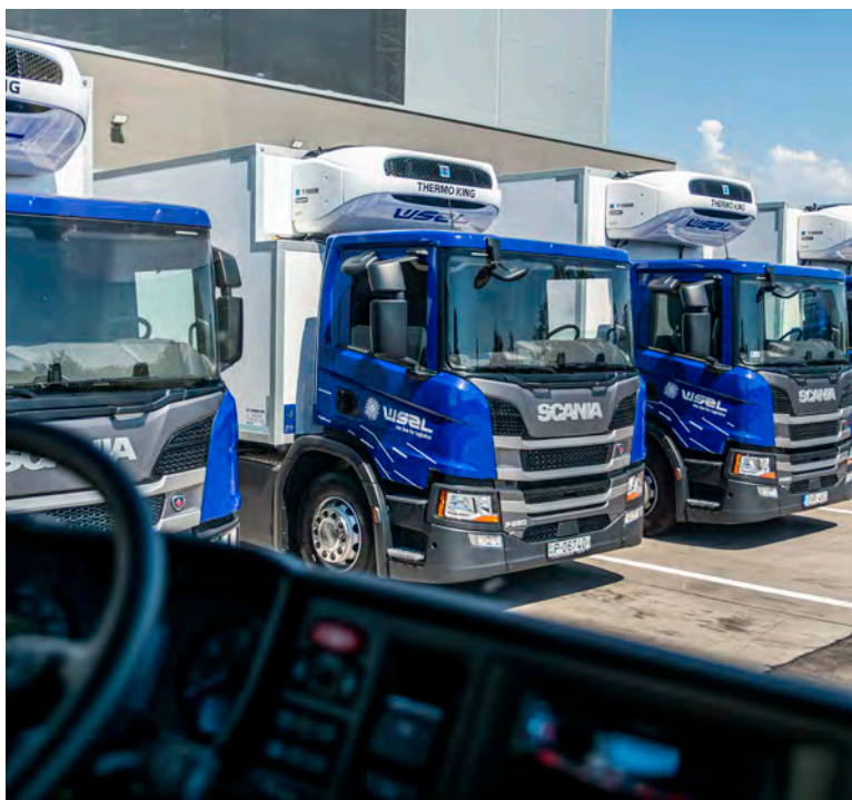
A Scania P 280 tehergépkocsikra az Aldi elvárásainak megfelelően olyan különleges, hőszigetelt dobozos felépítmények kerültek, amelyek egyszerre alkalmasak száraz-, hűtött és fagyasztott áruk szállítására.
